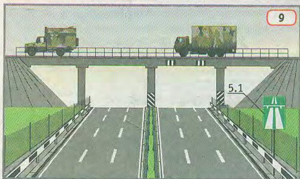
Основні елементи дороги поза населеними пунктами: a – розділювальна смуга; б – проїзна частина для руху в одному напрямку; в – узбіччя; г – кювет; д – обріз; е – смуга відведення; є – смуга руху; ж – край проїзної частини
